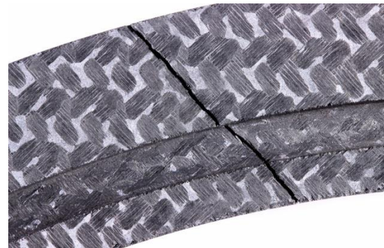
Bruch in einem kohlefaserverstärktem Bauteil
