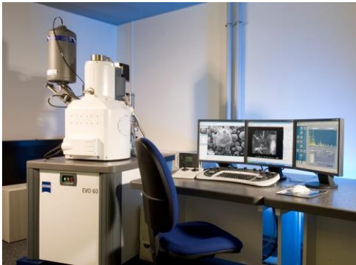
Rasterelektronenmikroskop (REM) mit EDX Analysator
