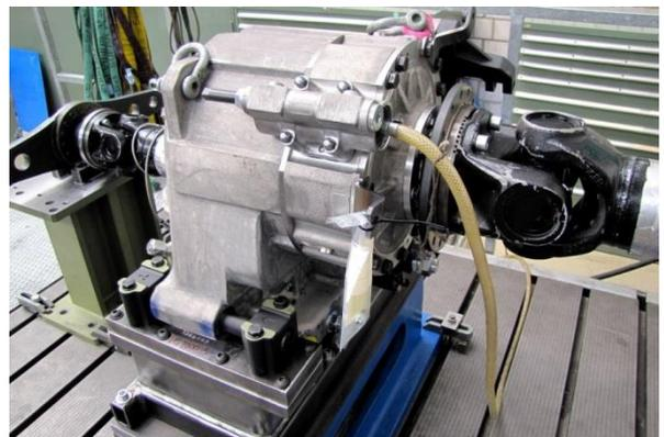
Bauteilermüdung – Getriebe im Test
