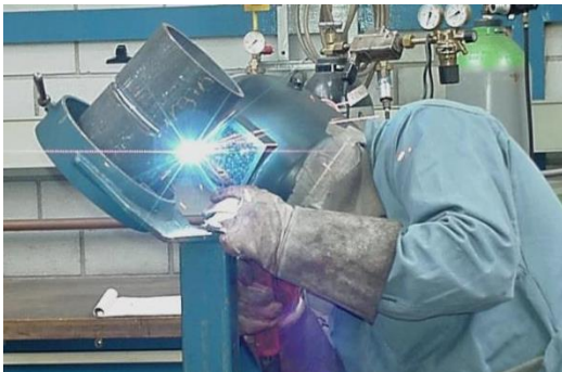
Schweisserprüfung nach EN ISO 9606-4
