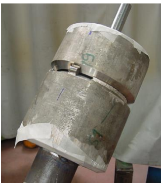
Rohr in Schweissposition H-L045 (45°)
