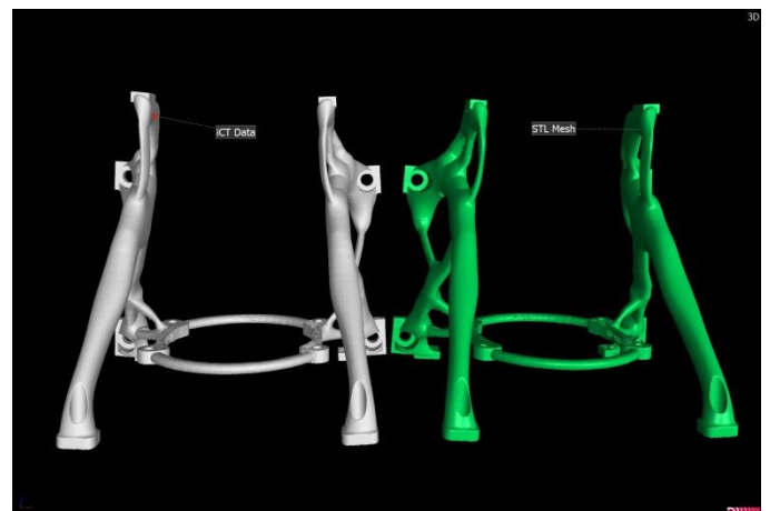
Scan einer Kamerahalterung für einen Satelliten (KTI CSEM-BFH-SIPBB-ProtoShape) Links: Gescannter Halter; Rechts: STL-File
