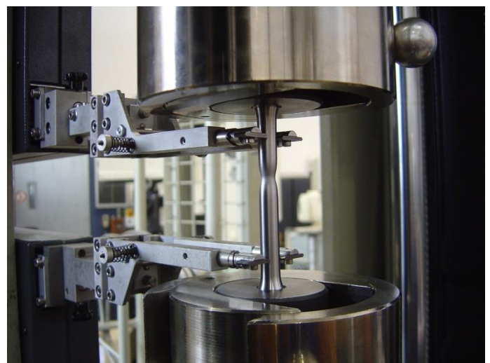
Zugversuch an einer SLM Rundprobe
